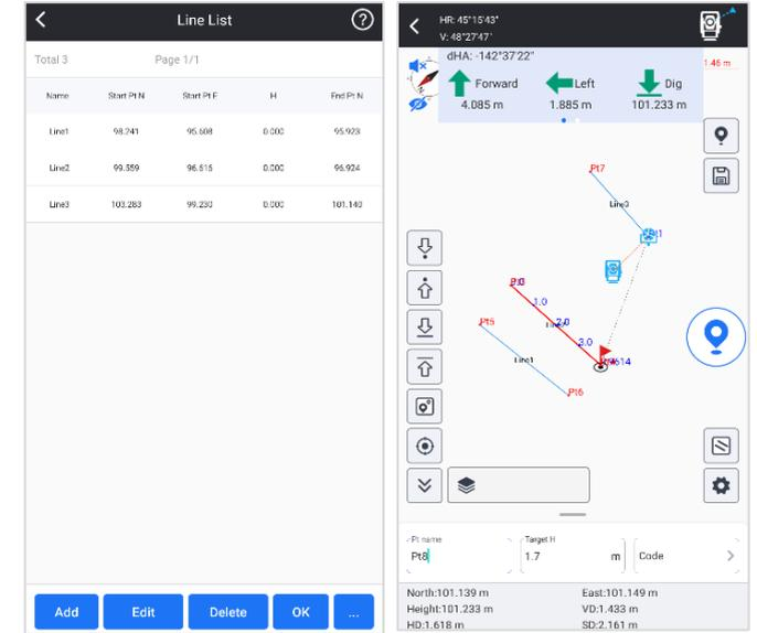
El usuario puede elegir manualmente los puntos de la biblioteca, la línea será formada por el programa automáticamente. Luego, la distancia del intervalo de entrada del usuario, los puntos de configuración se calcularán y se mostrarán en la pantalla.
