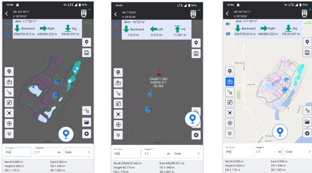
CAD Stakeout le permite importar un mapa base CAD y replantearlo, sin coordenadas de puntos de entrada uno por uno.
